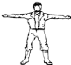
ordem de parada para todos os veículos que venham de direções que cortem ortogonalmente a direção indicada pelos braços estendidos, qualquer que seja o sentido do seu deslocamento
